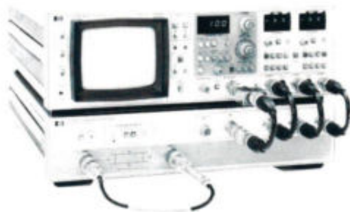
De HP 8754A netwerk analyzer (met uitbreiding H26), hier afgebeeld met de bijpassende S-parameter testset. Geschikt voor metingen met frequentievaai; van 4 MHz - 2,6 GHz.
