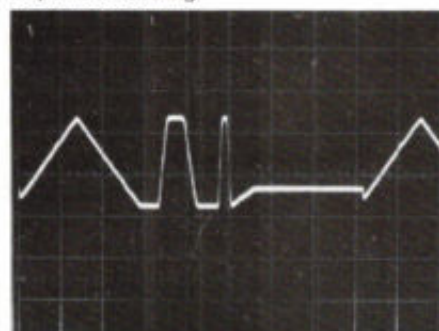
Afb. 9. XY-vorm. Standen: REPEAT; 4096; 20-punts smoothing.
