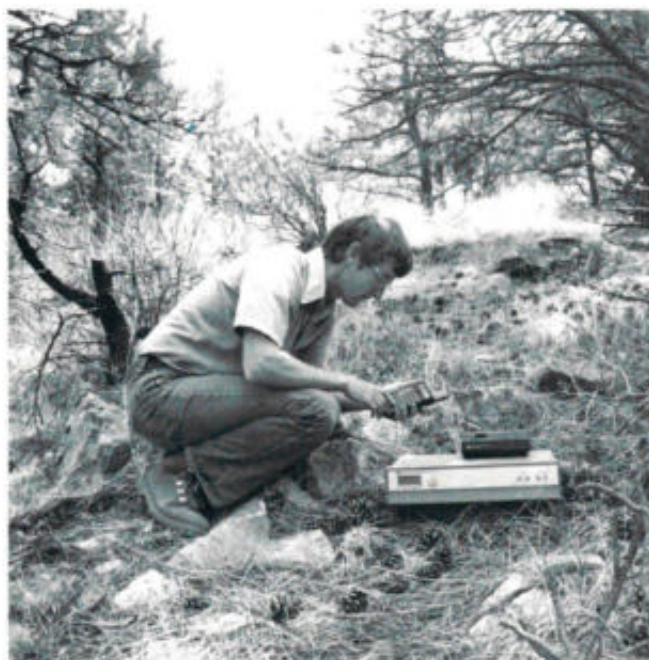
Met de 3421A meet men grondtemperatuur op 30 plaatsen om na te gaan hoe de houtkap de sterfte onder nieuwe aanplant beïnvloedt.
