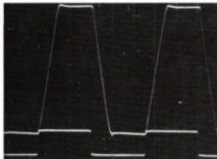
Afb. 10. Illustratie van de stijgtijden van de versterker.
